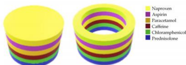
Figura 29.- Diseños 3D de printlets para incorporación simultánea de varios fármacos. Tipo I: Cilindro (izquierdo, 10 mm de diámetro y 3 mm de altura), Tipos II y III: Anillo (derecho, 10 mm de diámetro y 6 mm de alto) (Robles-Martínez P y cols. 2019). Creative Commons Attribution 4.0 International License.
